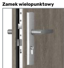
Zamek wielopunktowy RC2 – rozstaw klamki 72 mm RC3 – rozstaw klamki 92 mm
